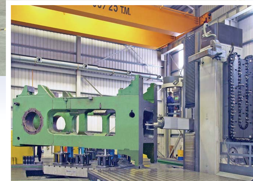
Mecanizado de prensa 130 tn. Machining of 130 ton press
